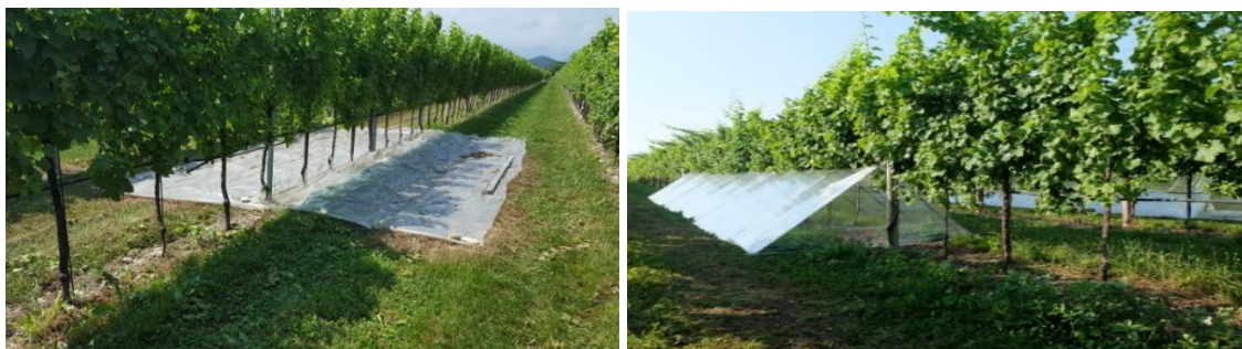
Slika 2. Tla, prekrita s folijo EVA, za vzpostavitev sušnega stresa (levo) in komora z odprtim vrhom za vzpostavitev toplotnega stresa (desno) v vinogradu sorte 'Sauvignon' v Sequalsu leta 2021.
